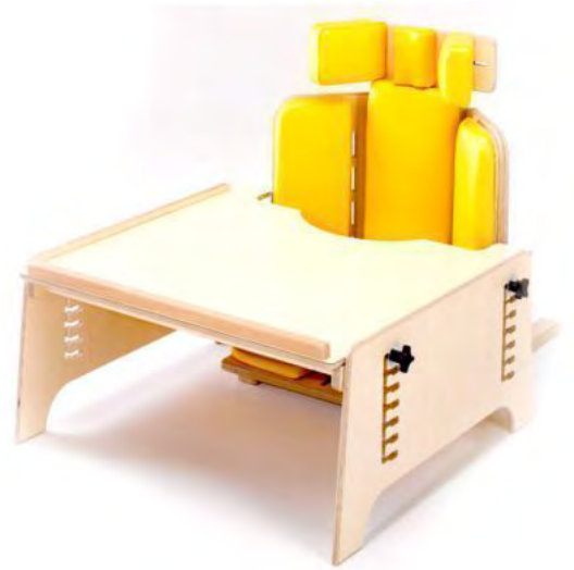
Bordet ställs i höjd och vinkel med hjälp av rattar och skåror på bordets sidodelar.
